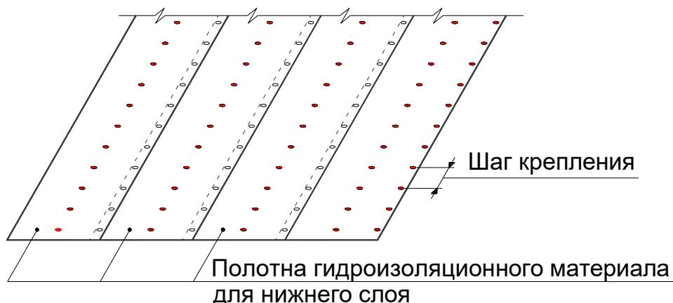
*Рисунок 6.6 – Схема крепления материалов по центру рулона*
