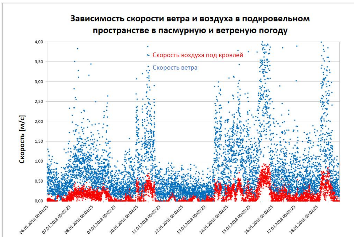
Рис. 12: Движение воздуха между мембраной и кровлей, вызванное ветром в пасмурную погоду (Источник: Dörken GmbH & Co. KG)
